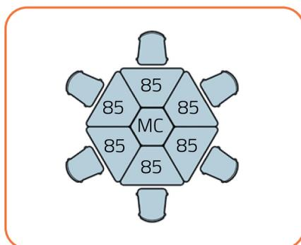
Isola centrale per tavolo trapezio con lato da 85 cm. Piano realizzato in melamminico da 25 mm, con angoli a raggio minimo di 44 mm. Tutti i bordi e gli angoli del piano sono raggiati a norma antinfortunistica con raggio 3mm. L'isola è dotata di ruote frenanti per un più agevole spostamento all'interno della classe.
